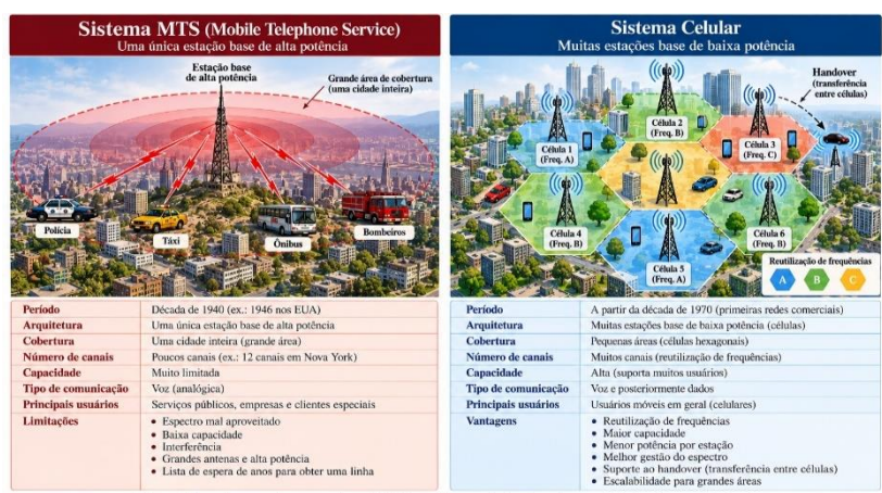
Figura 1.2 — Comparação entre o sistema MTS (uma única estação base) e o sistema celular (muitas estações base), mostrando a evolução da arquitetura, cobertura e capacidade.
